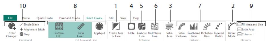
Dessin pour ajouter des trous (4), des lignes en relief (5) et des lignes MultiWave (6) pour remplir des zones, et pour créer des colonnes de satin, de satin à plumes, des barres Richelieu et des colonnes à motifs coniques (7). Choisissez le type de point pour les lignes et les remplissages (8), puis réglez les propriétés de vos types de points (9). Ajoutez des couleurs, des points simples et des points d'alignement et des commandes d'arrêt (10).
